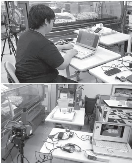
図3：高濃度酸素（95%O<sub>2</sub>）暴露による使いすてかいろの温度計測
