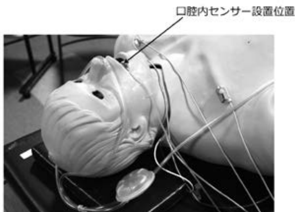
図1 口元における酸素濃度測定部位 酸素濃度測定に使用したシミュレータと口元での測定部位
