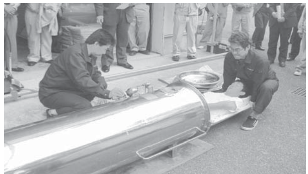
図2 一人用小型再圧室（ワンマンチャンバ）
