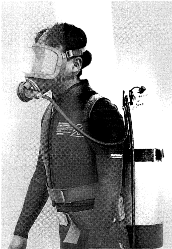
図2 スクーバ潜水器 (全面マスク式、AGA)
