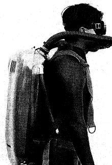
図15 半閉式スクーバ潜水器 (ドレーゲル FGG-III)
