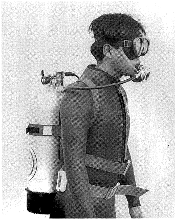
図1 スクーバ潜水器 (解放式スクーバ、面マスク式)
