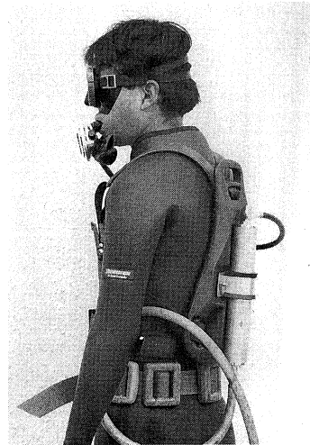
図3 フーカー潜水器 (解放式他給気)
