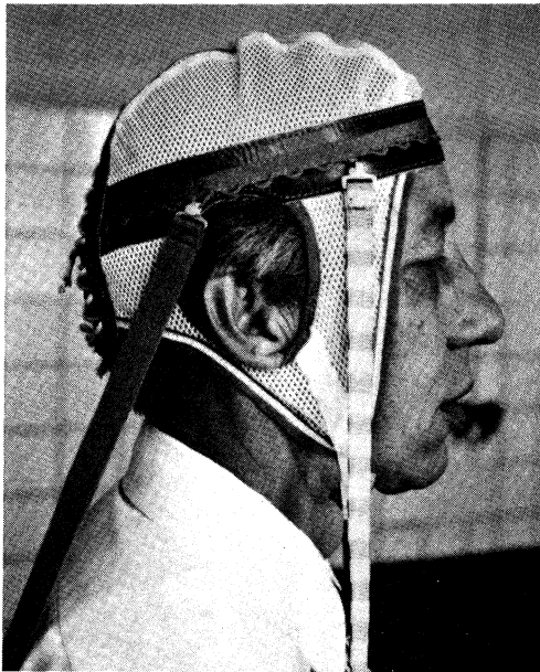
図3 宇宙酔い防止のための頭部拘束装置
